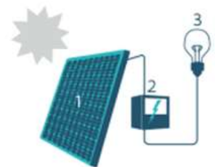
1. Zonnepaneel | 2. Omvormer | 3. Elektrische toestellen
